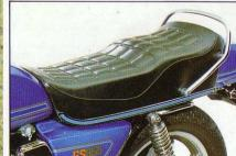
langen Strecken nicht so schnell ermüden. Die Stufe gibt dem Fahrer Halt, der Bügel dem Beifahrer.
