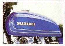
Der Tank faßt 22 I, so daß auch auf langen Strecken ein guter Schnitt erzielt werden kann. Die GS 850 G besitzt den pneumatischen Kraftstoffhahn, der sich nur bei laufendem Motor öffnet.
