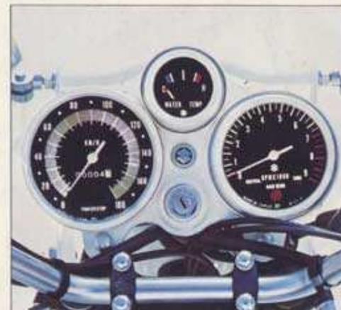
Temperaturanzeiger – Geschwindigkeitsmesser – Drehzahlmesser – Zündschloß – Fernlicht – Leerlaufanzeiger und Blinkerkontrolle
