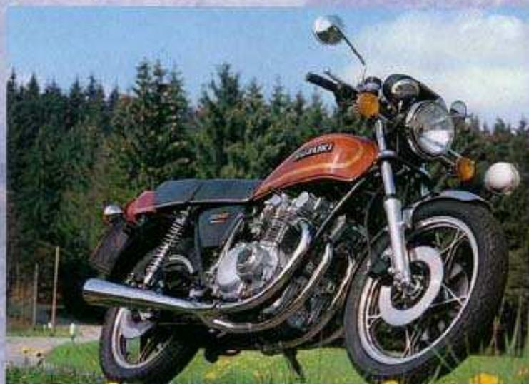
Die GS 550 sieht ihrer größeren Schwester zum Verwechseln ähnlich, ist mit 36 kW (49 PS) kaum leistungsschwächer, dafür ein wenig leichter, preisgünstiger. Die Testbeste unter den Fünfhundertern schließt die Lücke zwischen der Zweizylinder GS 400 und der testbesten Dreiviertelliter-Maschine.
