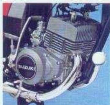
Der Zweizylinder-2-Taktmotor mit 20 kW (27 PS) ist das jüngste Ergebnis der SUZUKI-Forschung. Er ist schlitzmembrangesteuert, hat wartungsfreie, kontaktlose, elektronische Zündung und – bei SUZUKI selbstverständlich – CCI-Getrennt-Schmierung, 6-Gang-Getriebe.
