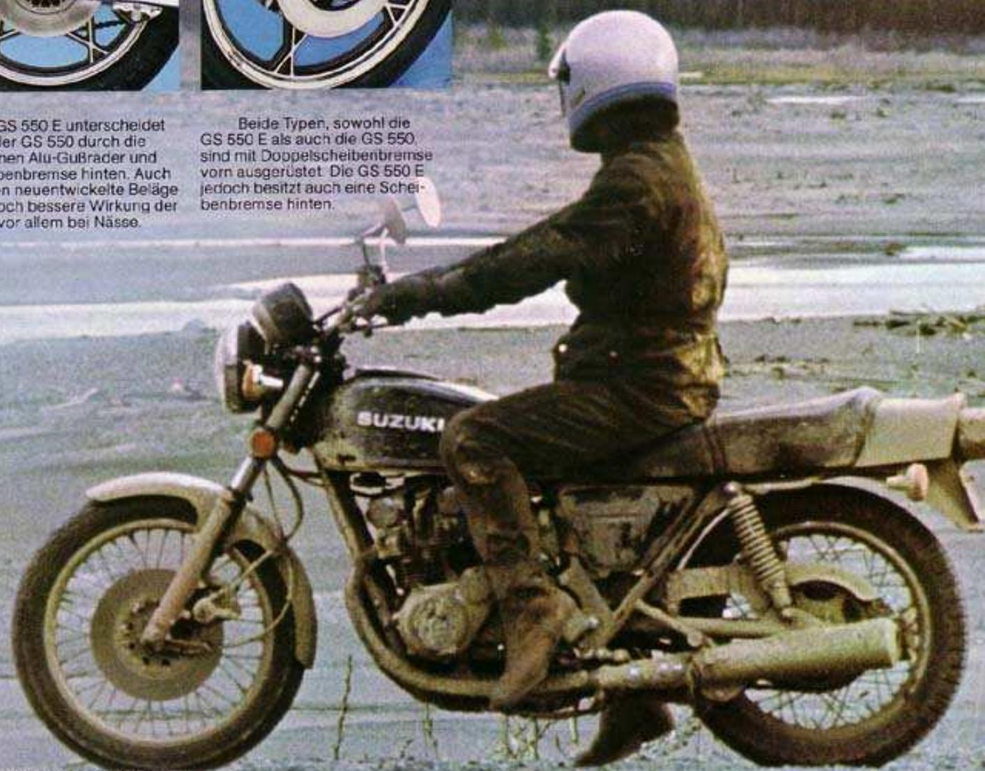
Erst recht bei einer Maschine mit 6-Ganggetriebe ist der Fahrer für die Digital-Ganganzeige dankbar. Hebel und Armaturen liegen griffgünstig. Und die beiden Spiegel sind – wie bei allen SUZUKI-Viertakt-Modellen – vibrationsarm in Gummi gelagert.
