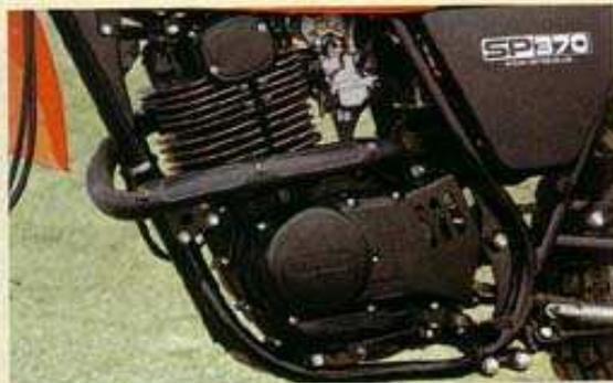
Der Einzylinder-Viertaktmotor mit 369 ccm leistet 20 kW (27 PS) bei 7500 /min. Am Leichtgewicht der ganzen Maschine – 131 kg fahrfertig! – hat er seinen Anteil. Er besitzt Naßsumpschmierung – hat also das Öl im Motor – und für das Gehäuse wurde viel Magnesium verwendet.
