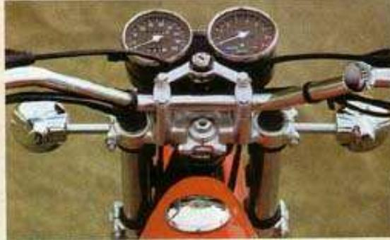
Die Tank-Sitzbank-Kombination ist anatomisch günstig gestaltet, der Lenker ideal geformt. Tachometer und Drehzahlmesser sind ebenso vorhanden wie eine Blinkanlage. Brems- und Kupplungshebel sind gegen Schmutz und Wasser geschützt.
