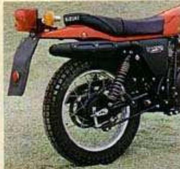
Die Gasdruckfederbeine haben einen Federweg von 160 mm, die Telegabel 200 mm – Idealwerte für eine Enduro. Um das gefürchtete Springen der Hinterhand beim Bremsen auszuschließen, ist hier der Zuganker der Hinterradbremse nicht am Schwingerholm, sondern am Rahmenunterzug angeleitet.
