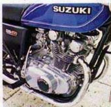
Auch der Zweizylinder-SUZUKI-Motor hat zwei obenliegende Nockenwellen aufzuweisen. Seine ungewöhnliche Laufruhe bezieht er von dem wendigen Kurbelwellenschwungausgleich über Zahnräder.
