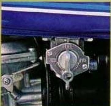
Wie bei allen SUZUKI-Viertakttern muß auch der Benzinahn der Vierhunderter nicht abgesperrt werden. Er besitzt ein pneumatisches Ventil, das sich nur bei laufendem Motor öffnet.
