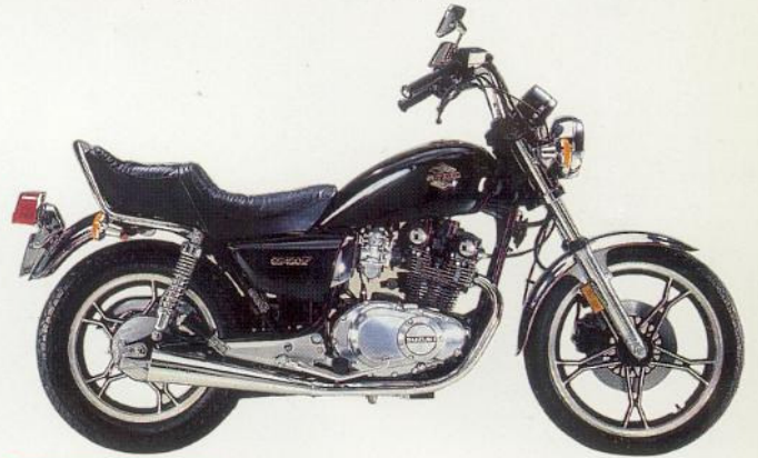
GS 450 L 2-Zylinder, 4-Takt, 444 cm 3 , 27 PS/20 kW bei 7400 min -1 , DOHC, 6 Gänge, 130 km/h, Doppelschleifenrohr-rahmen, kontaktlose Transistorzündung, 12 V/12 Ah Batterie, 13-l-Tank. Farben: Schwarz, Rot.
