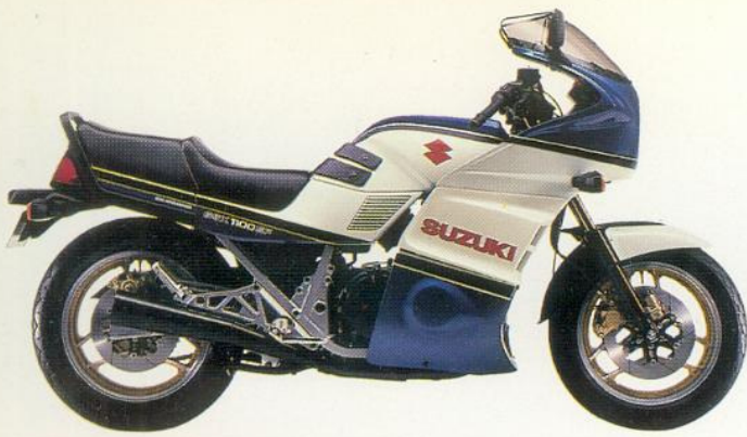
GSX 1100 EF 4-Zylinder, 4-Takt, 1128 cm 3 , 100 PS/74 kW bei 8100 min -1 , 96,9 Nm bei 6500 min -1 , DOHC, 16 Ventile, 5 Gänge, über 200 km/h, 3 Scheibenbremsen, kontaktlose Transistorspulen-zündung, O-Ring-Kette, 20-l-Tank. Farben: Rot/Weiß, Blau/Weiß.
