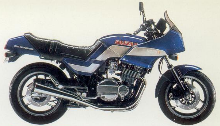
GSX 750 ES 4-Zylinder, 4-Takt, 742 cm 3 , 86 PS/63 kW bei 9500 min -1 , 66,4 Nm bei 8500 min -1 , DOHC, 16 Ventile, 5 Gänge, O-Ring-Kette, über 200 km/h, Anti-Dive, 3 Scheibenbremsen, kontaktlose Transistorzündung, 20-l-Tank. Farbe: Blau/Silber.
