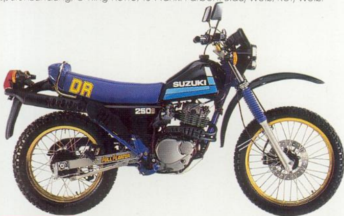
DR 250 S 1-Zylindermotor, 4-Takt, 246 cm 3 , 17 PS/13 kW bei 7800 min -1 , 17,4 Nm bei 4000 min -1 , OHC, 4 Ventile, 5 Gänge, 123 km/h, Einrohrrahmen mit geteilten Unterzügen, Schwinge mit Zentralfederbein Full-Floater, vorne hydraulische Scheibenbremse, kontaktlose Zündung, 10-l-Tank. Farben: Schwarz, Weiß, Rot.
