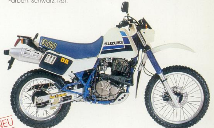
DR 600 S 1-Zylinder, 4-Takt, 585 cm 3 , 45 PS/33 kW bei 6800 min -1 , 27 PS/20 kW bei 6200 min -1 , OHC, 4 Ventile, 5 Gänge, O-Ring-Kette, 156 km/h/131 km/h, kontaktlose Doppelzündung, 20-l-Tank. Farben: Weiß, Schwarz, Rot, Blau.
