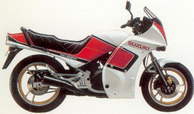
GSX 550 EF 4-Zylinder, 4-Takt, 567 cm 3 , 68 PS/50 kW bei 10000 min -1 , 49,9 Nm bei 8000 min -1 , 16 Ventile, 6 Gänge, 193 km/h, Anti-Dive, 3 Scheibenbremsen, kontaktlose Transistorspulenzündung, O-Ring-Kette, 18-l-Tank. Farben: Blau/Weiß, Rot/Weiß.
