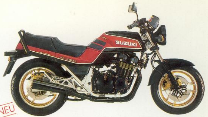
GSX 1100 E 4-Zylinder, 4-Takt, 1128 cm 3 , 100 PS/74 kW bei 8100 min -1 , 96,9 Nm bei 6500 min -1 , DOHC, 16 Ventile, 5 Gänge, über 200 km/h, 3 Scheibenbremsen, kontaktlose Transistorspulen-zündung, O-Ring-Kette, 20-l-Tank. Farben: Rot/Schwarz, Blau/Weiß.
