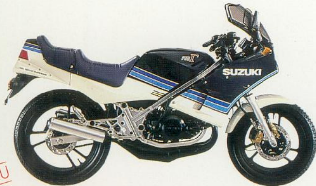
RG 250 Gamma 2-Zylinder, 2-Takt, flüssigkeitsgekühlt, 247 cm 3 , 46 PS/34 kW bei 8500 min -1 , 39 Nm bei 8000 min -1 , 6 Gänge, O-Ring-Kette, 170 km/h, kontaktlose Zündung, Vierkant-Alu-Rahmen, Anti-Dive, 3 Scheibenbremsen, 146 kg fahrbereit, 17-l-Tank. Farbe: Dunkel-Blau/Weiß.
