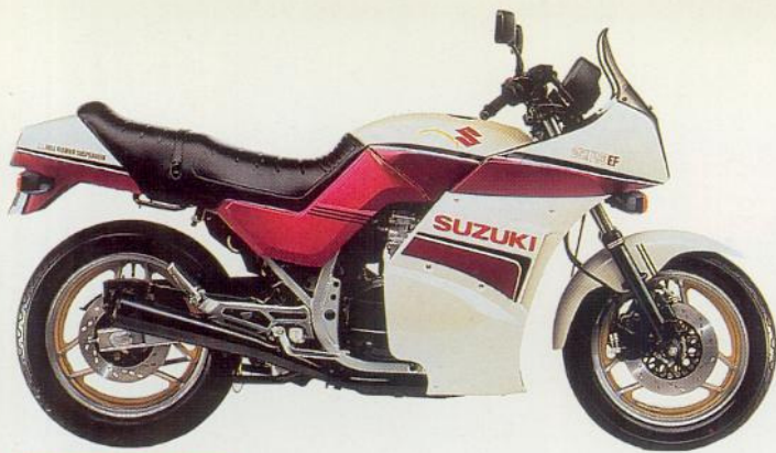
GSX 750 EF 4-Zylinder, 4-Takt, 742 cm 3 , 86 PS/63 kW bei 9500 min -1 , 66,4 Nm bei 8500 min -1 , DOHC, 16 Ventile, 5 Gänge, O-Ring-Kette, über 200 km/h, Anti-Dive, 3 Scheibenbremsen, kontaktlose Transistorzündung, 20-l-Tank. Farbe: Rot/Weiß.
