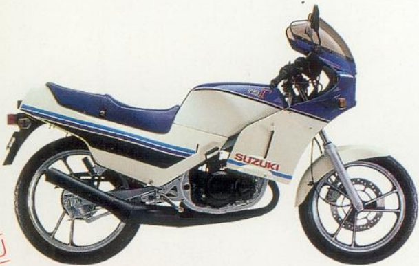
RG 80 Gamma 1-Zylinder, 2-Takt, flüssigkeitsgekühlt, 79 cm 3 , 9,9 PS/7,28 kW/5900 min -1 , 6 Gänge, Vierkant-Rahmen, hydraulische Scheibenbremse, Ø 260 mm, kontaktlose Zündung, 12 V/4 Ah Batterie, 13-l-Tank. Farben: Rot/Weiß, Blau/Weiß.
