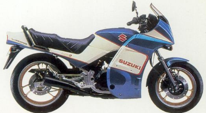
GSX 550 EF 4-Zylinder, 4-Takt, 567 cm 3 , 64 PS/47 kW bei 10000 min -1 , 48 Nm bei 8000 min -1 , DOHC, 16 Ventile, 6 Gänge, O-Ring-Kette, 190 km/h, Anti-Dive, 3 Scheibenbremsen, kontaktlose Transistorzündung, 18-l-Tank. Farbe: Blau/Weiß.
