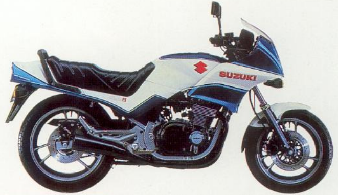
GSX 550 ES 4-Zylinder, 4-Takt, 567 cm 3 , 64 PS/47 kW bei 10000 min -1 , 48 Nm bei 8000 min -1 , DOHC, 16 Ventile, 6 Gänge, O-Ring-Kette, 190 km/h, Anti-Dive, 3 Scheibenbremsen, kontaktlose Transistorzündung, 18-l-Tank. Farbe: Blau/Weiß.
