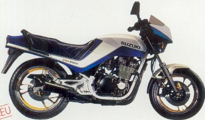
GSX 550 EU 4-Zylinder, 4-Takt, 567 cm 3 , 50 PS/37 kW bei 9600 min -1 , 42,2 Nm bei 7650 min -1 , DOHC, 16 Ventile, 6 Gänge, 170 km/h, Anti-Dive, 3 Scheibenbremsen, kontaktlose Transistorzündung, O-Ring-Kette, 18-l-Tank. Farben: Blau/Weiß, Rot/Weiß.
