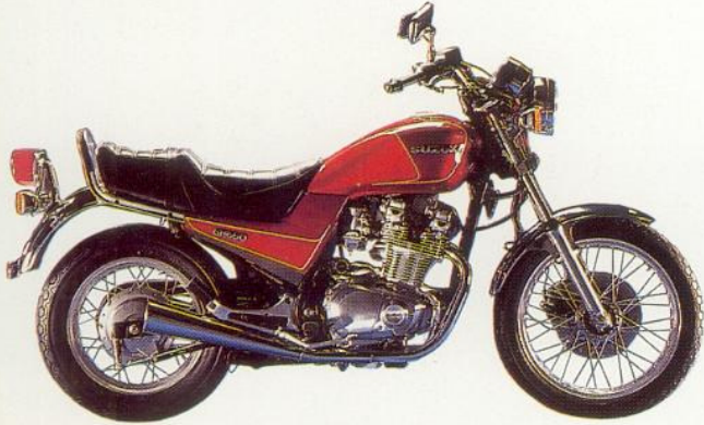
GR 650 2-Zylinder, 4-Takt, 647 cm 3 , 50 PS/37 kW bei 7200 min -1 , 51 Nm bei 6000 min -1 , DOHC, 5 Gänge, O-Ring-Kette, 167 km/h, kontaktlose Transistorspulen-zündung, 12-l-Tank. Farbe: Rot.
