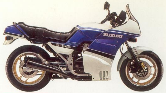
GSX 750 EF 4-Zylinder, 4-Takt, 742 cm 3 , 90 PS/66 kW bei 9500 min -1 , 67,7 Nm bei 8500 min -1 , DOHC, 16 Ventile, 5 Gänge, O-Ring-Kette, über 200 km/h, Anti-Dive, 3 Scheibenbremsen, kontaktlose Transistorspulenzündung, 20-l-Tank. Farben: Blau/Weiß, Rot/Weiß.
