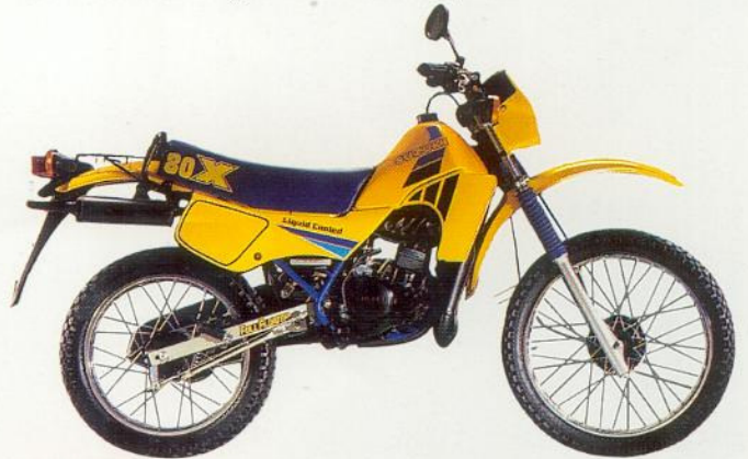
TS 80 X 1-Zylinder, 2-Takt, flüssigkeitsgekühlt, 79 cm 3 , 9,5 PS/7 kW bei 5900 min -1 , 10,6 Nm bei 5800 min -1 , 6 Gänge, 80 km/h, kontaktlose Zündung, 12 V/4 Ah Batterie, 8-l-Tank. Farben: Gelb, Weiß, Rot.
