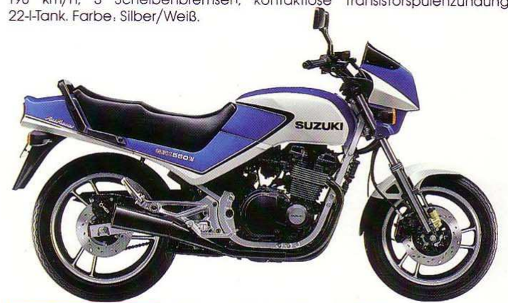
GSX 550 EU 4-Zylinder, 4-Takt, 567 cm 3 , 50 PS/37 kW bei 9600 min -1 , 42,2 Nm bei 7650 min -1 , DOHC, 16 Ventile, 6 Gänge, 170 km/h, Anti-Dive, 3 Scheibenbremsen, kontaktlose Transistorpulen-zündung, O-Ring-Kette, 18-l-Tank. Farben: Blau/Weiß, Rot/Schwarz.
