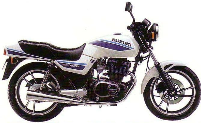
GSX 400 E 2-Zylinder, 4-Takt, 395 cm 3 , 27 PS/20 kW bei 7800 min -1 , DOHC, 8 Ventile, 6 Gänge, 142 km/h, 12 V/14 Ah Batterie, Doppel-Schleifen-Rahmen, 16-l-Tank. Farbe: Weiß.
