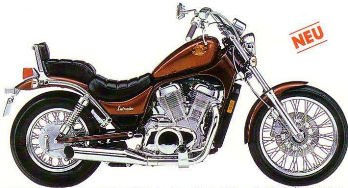
VS 750 Intruder 2-Zylinder, 4-Takt, 747 cm 3 , 50 PS/37 kW bei 6800 min -1 , 56,7 Nm bei 5200 min -1 , 5 Gänge, Kardan, kontaktlose Transistorspulen-zündung, 12-l-Tank. Farbe: Candy Marun.
