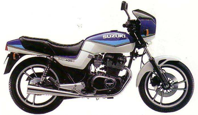
GSX 400 S 2-Zylinder, 4-Takt, 395 cm 3 , 27 PS/20 kW bei 7800 min -1 , DOHC, 8 Ventile, 6 Gänge, 142 km/h, 12 V/14 Ah Tank. Farben: Rot/Schwarz, Blau/Weiß.
