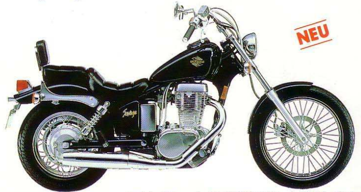
LS 650 1-Zylinder, 4-Takt, 652 cm 3 , 27 PS/20 kW bei 5300 min -1 , 4 Gänge, E-Starter mit automatischer Dekompression, Zahnriemen, kontaktlose Transistorspulen-zündung, 9,5-l-Tank, auch mit Flachlenker. Farben: Schwarz, Candy Marun.
