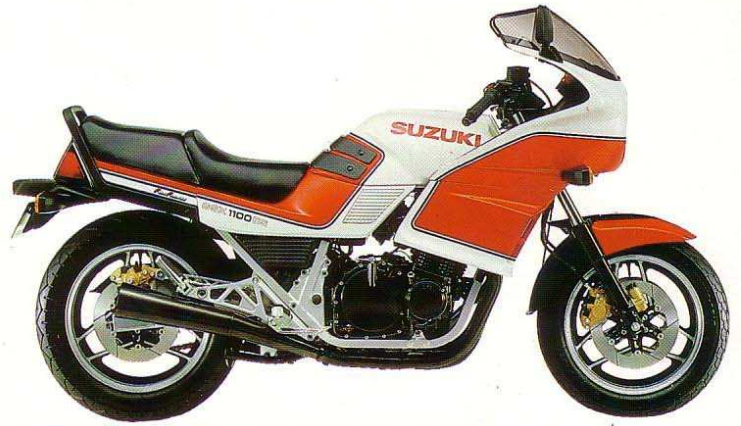
GSX 1100 ES 4-Zylinder, 4-Takt, 1128 cm 3 , 100 PS/74 kW bei 8100 min -1 , 96,9 Nm bei 6500 min -1 , DOHC, 16 Ventile, 5 Gänge, über 200 km/h, 3 Scheibenbremsen, kontaktlose Transistorspulen-zündung, O-Ring-Kette, 20-l-Tank. Farben: Rot/Schwarz, Rot/Weiß.
