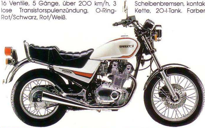
GR 650 2-Zylinder, 4-Takt, 647 cm 3 , 50 PS/37 kW bei 7200 min -1 , 51 Nm bei 6000 min -1 , DOHC, 5 Gänge, O-Ring-Kette, 167 km/h, kontaktlose Transistorpulen-zündung, 12-l-Tank. Farbe: Weiß.
