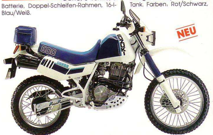
DR 600 R Dakar 1-Zylinder, 4-Takt, 585 cm 3 , 45 PS/33 kW bei 6800 min -1 , OHC, 4 Ventile, 5 Gänge, O-Ring-Kette, 156 km/h, kontaktlose Doppelzündung, 21-l-Tank. Farbe: Weiß.
