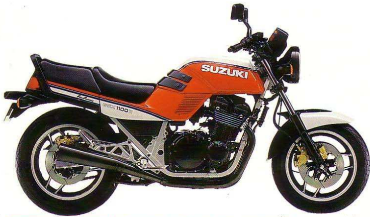
GSX 1100 E 4-Zylinder, 4-Takt, 1128 cm 3 , 100 PS/74 kW bei 8100 min -1 , 96,9 Nm bei 6500 min -1 , DOHC, 16 Ventile, 5 Gänge, über 200 km/h, 3 Scheibenbremsen, kontaktlose Transistorspulen-zündung, O-Ring-Kette, 20-l-Tank. Farben: Rot/Schwarz, Rot/Weiß.
