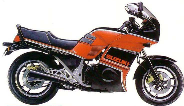
GSX 1100 EF 4-Zylinder, 4-Takt, 1128 cm 3 , 100 PS/74 kW bei 8100 min -1 , 96,9 Nm bei 6500 min -1 , DOHC, 16 Ventile, 5 Gänge, über 200 km/h, 3 Scheibenbremsen, kontaktlose Transistorpulen-zündung, O-Ring-Kette, 20-l-Tank. Farben: Rot/Schwarz, Rot/Weiß.
