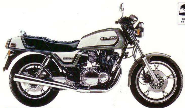
GS 850 G 4-Zylinder, 4-Takt, 837 cm 3 , 80 PS/59 kW bei 8500 min -1 , 69 Nm bei 7500 min -1 , DOHC, 8 Ventile, 5 Gänge, Kardan, 198 km/h, 3 Scheibenbremsen, kontaktlose Transistorpulen-zündung, 22-l-Tank. Farbe: Silber/Weiß.
