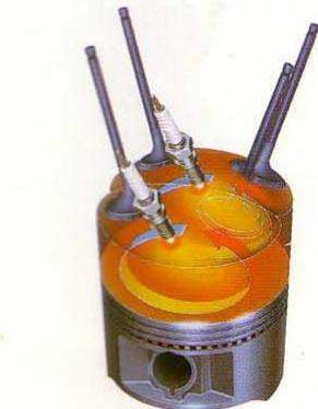
DR 600-Motor mit Doppelzündung. Beschleunigte Verbrennung durch zwei Zündkerzen, die den Brennraum-Hemisphären zugeordnet sind.
