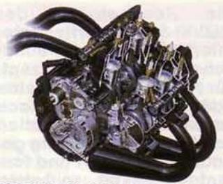
RG 500 Gamma, Square Four-Motor mit Drehschieber-Einlaß und Auslaßsteuerung. Breites Drehzahlband, hohe Spitzenleistung gewichtssparende Bauweise.
